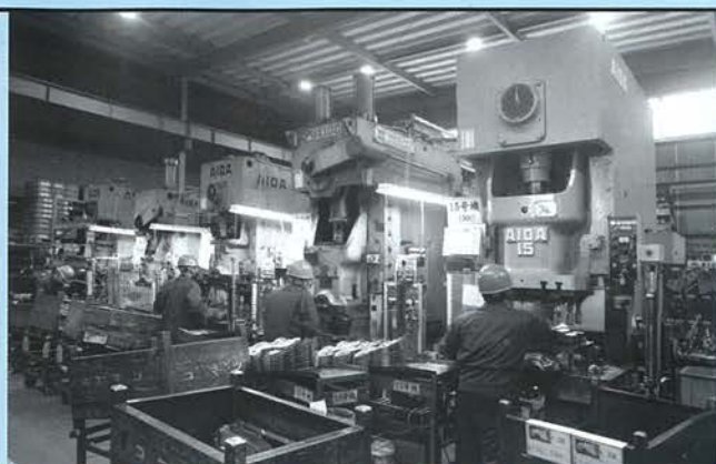
▲ NC1-1500(150トン)~80トン 5台順送プレスライン
